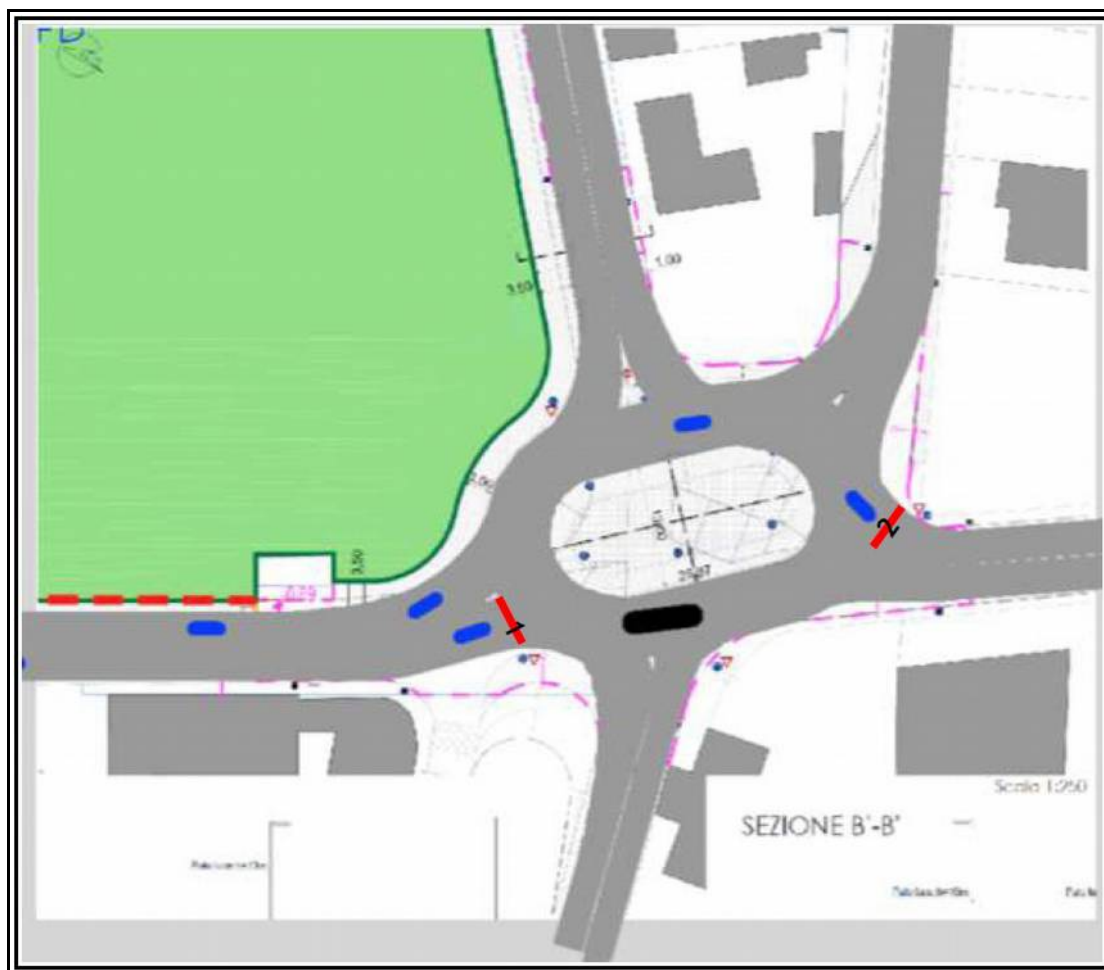
Illustr. 48: Verifica con il software Vissim dell'inserimento della rotatoria lungo la via Galilei.
