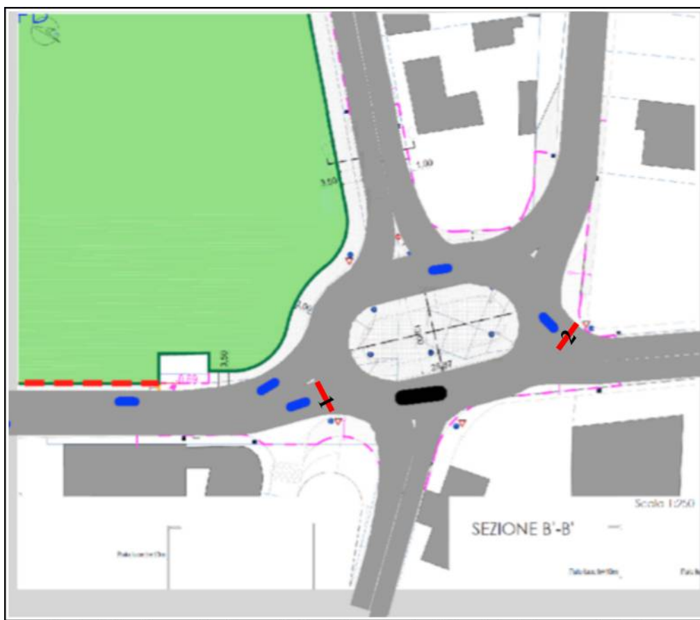
Illustr. 3: Verifica con il software Vissim dell'inserimento della rotatoria lungo la via Galilei.
